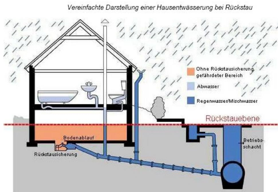
Diese beiden Auszüge aus Satzung und DIN-Norm lassen also klar erkennen, dass Rückstauverschluss und Hebeanlage vom Gesetz- bzw. Satzungsgeber zwingend vorgeschrieben sind.
