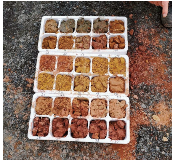
Auf dem Bild sieht man Bohrgut in Fächerkisten, das aus einer Versuchsbrunnenbohrung entnommen wurde. Quelle: ZMW, M. Schäfer
